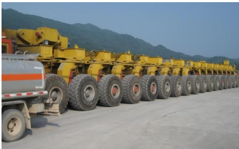
Фото 1. Транспорт мостових прольотів
